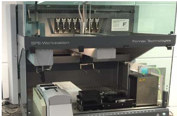
Basis: Tecan EVO® 100 mit Fornax SPE Prozessor, LiHA und RoMa
